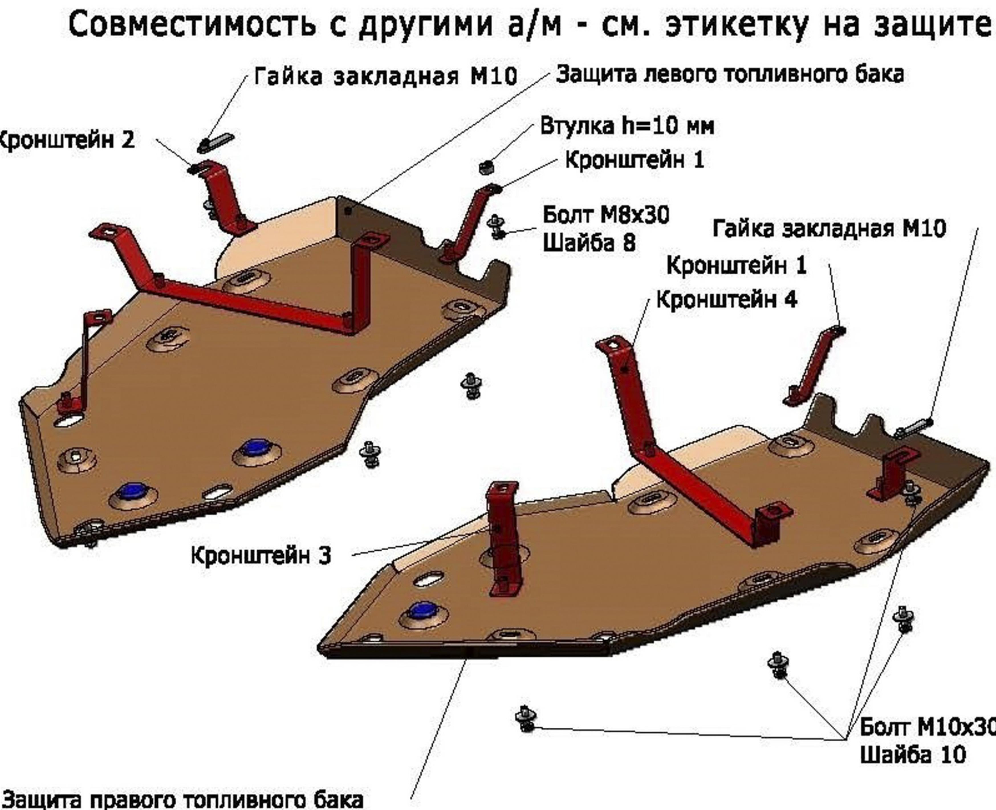
5. Закрепить защиты топливных баков к установленным кронштейнам болтами M10x30.
