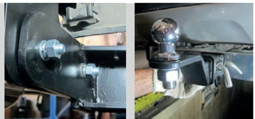
Тип соединения: шаровый; Диаметр сцепного шара: 50 мм.; Масса комплекта ТСУ 06051501: 25 кг.
