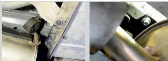
**ШАГ 4.** Для установки центрального кронштейна, вставьте в буксирную петлю две шайбы 28х13 из комплекта поставки. Затем совместив отверстие в центре балки с отверстиями в шайбах закрепите всё с помощью болта М12х60х1,25 с гайкой М12х1,25 через две шайбы М12 с двух сторон и гровер М12. Затем соедините боковые кронштейны с центральной балкой болтами М10х40х1,25 через шайбы М10 и гайки М10.
