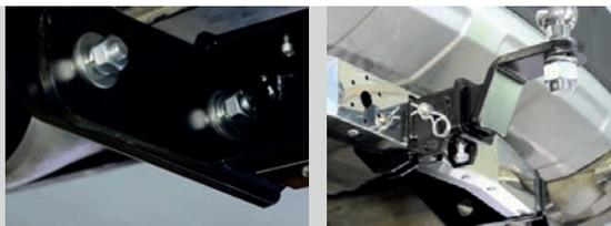
Тип соединения: шаровый; Диаметр сцепного шара: 50 мм.; Масса комплекта ТСУ 17011501: 21,6 кг.
