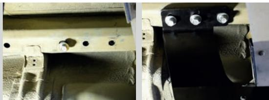
**ШАГ 3.** Для удобства установки правого кронштейна отсоедините крепление глушителя автомобиля и повторите шаги 1 и 2.
