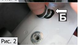
2.Закрутить болт M8x20 с шайбой 8 в планку закладную на 5-7 оборотов. Завести планку закладную с вкрученным болтом в штатное отверстие **Б** на кузове автомобиля. (рис.2)
