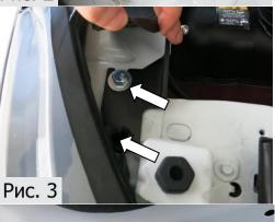
3. Сдвинуть кронштейн до упора к радиатору и в сторону моторного отсека. Затянуть болт М8х20 торцевой головкой №13 с усилием 20 Нм. Закрутить в штатную резьбу и затянуть штатный болт торцевой головкой №8 с усилием 9 Нм. (рис.3).
