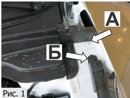
1. Торцевой головкой №10 выкрутить болт крепления крыла (А) и болт крепления фары (Б), (Рис.1).
