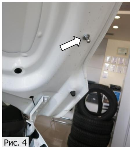
4. Вкрутить в планку закладную болт-шарнир с шайбой 6 пружинной, шайбой 6 и шайбой 6 пластиковой. Затянуть болт-шарнир торцевой головкой №10 с усилием 9 Нм, (Рис.4).
