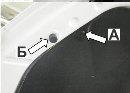
3. Демонтировать пистон (А) крепления обшивки капота. Выкрутить резиновый упор капота (Б) и запомнить количество оборотов, (Рис.3).
