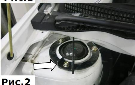
2. Установить кронштейн, зафиксировав его гайкой M8 спец. с шайбой 10. Сдвинуть кронштейн до упора в сторону лобового стекла. Затянуть гайку M8 спец. торцевой головкой №13 с усилием 23 Нм., (Рис.2).
