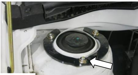
1. Торцевой головкой №13 открутить гайку крепления опоры передней подвески, (Рис.1).
