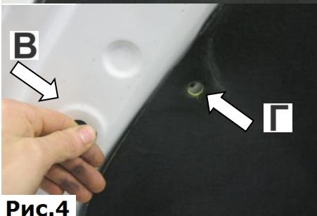
4. Держась за проволоку, завести планку закладную в отверстие (В) от резинового упора. Совместить резьбовое отверстие в планке закладной с отверстием (Г) в усилителе капота от демонтированного пистона, (Рис.4).
