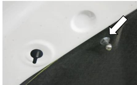
5. Вкрутить в планку закладную болт-шарнир с шайбой 6. Затянуть болт-шарнир высокой торцевой головкой №10 с усилием 9 Нм, (Рис.5).
