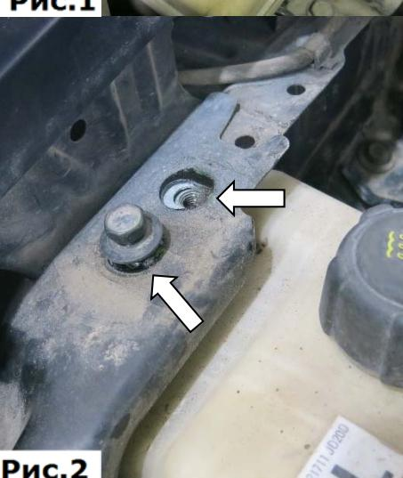
2. Открутить верхний болт крепления передней панели, нижний болт ослабить до обеспечения необходимого зазора в 6 мм, торцевой головкой №13, (Рис.2).
